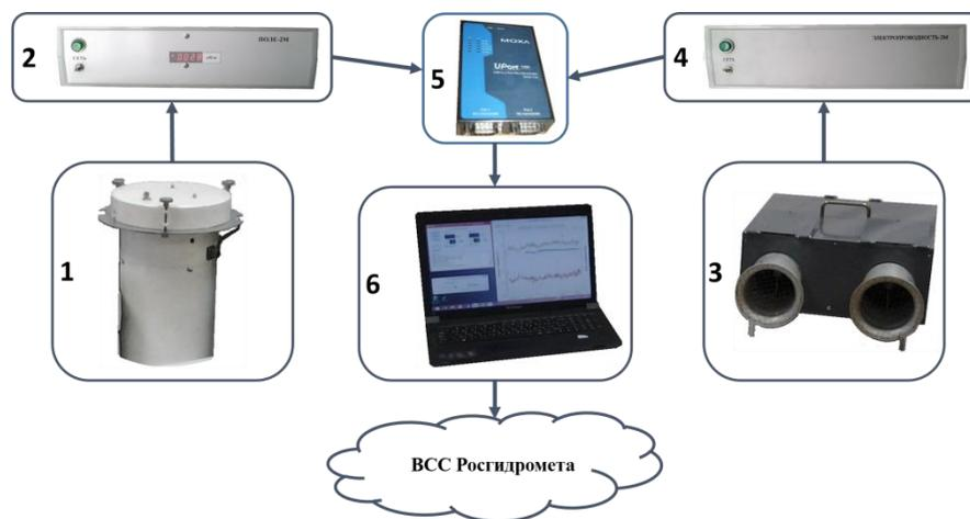
1 - ВБ измерителя "Поле-2М"; 2 - БПС измерителя "Поле-2М"; 3 - ВБ измерителя "Электропроводность-2М"; 4 - БПС измерителя "Электропроводность-2М"; 5 - ПИ; 6 - ПК для регистрации результатов измерений
