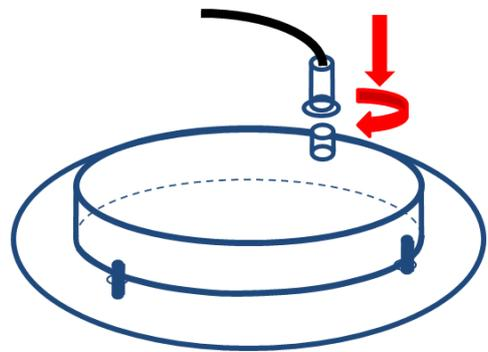
Рисунок 6 – Подключение кабеля
