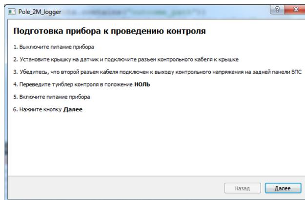
Рисунок 4 – Окно диалога подготовки прибора к измерительному контролю
