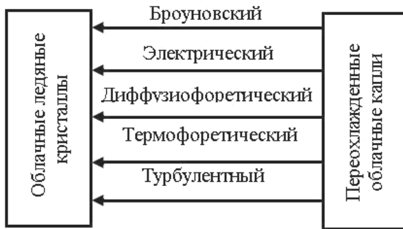
Рис. 3. Возможные контактные механизмы замерзания облачных капель.
