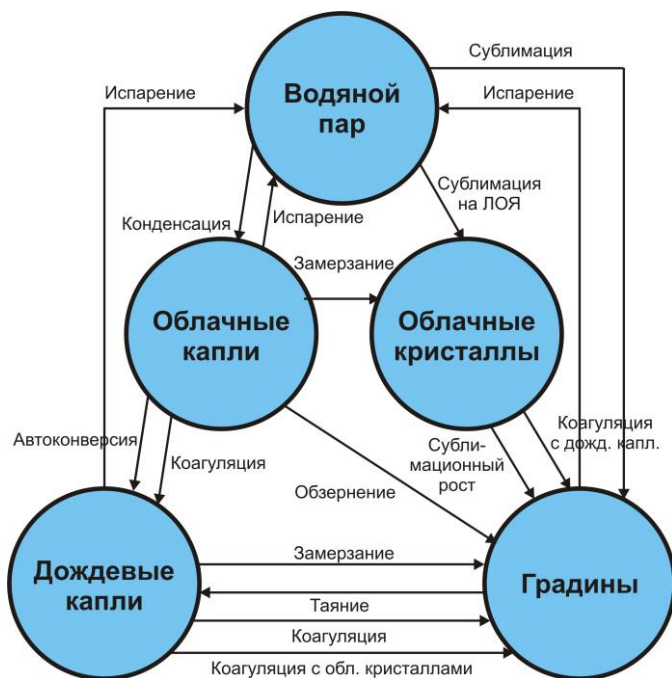
Рис. 4. Схема баланса влаги для случая трехфазного облака с учетом облачного льда.
