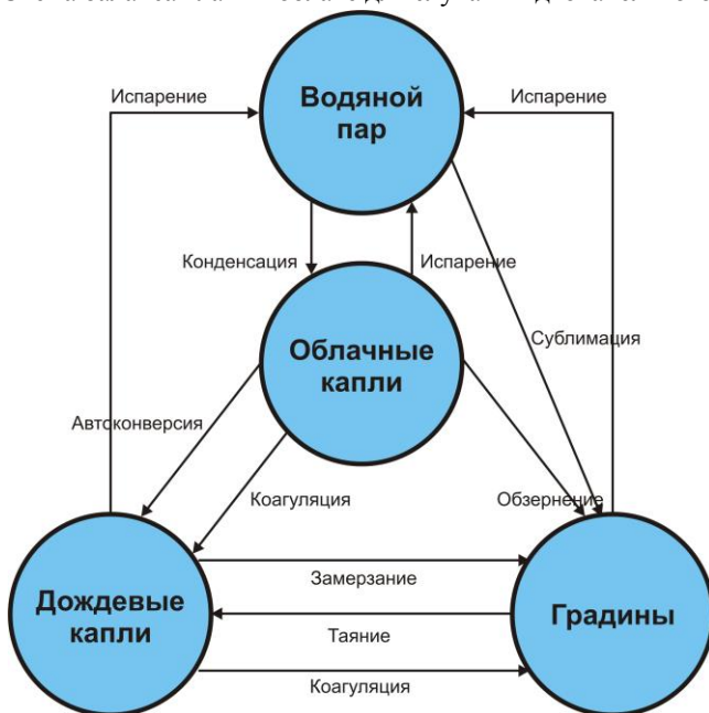
Рис. 3. Схема баланса влаги для случая трехфазного облака без учета облачного льда
