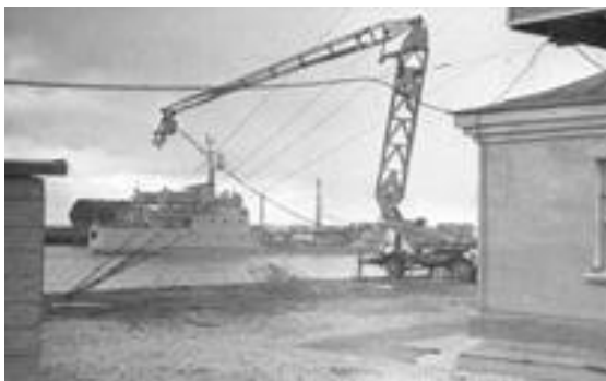
Рис. 4. Исследования коэффициента излучения \Sigma морской поверхности для решения военно-прикладных задач, проводившиеся в рамках натурального эксперимента с использованием опорно-поворотной системы. Финский залив, морской порт г. Ломоносова, \Lambda = 1, 6—8, 5 см, рупорно-параболическая антенная система.
