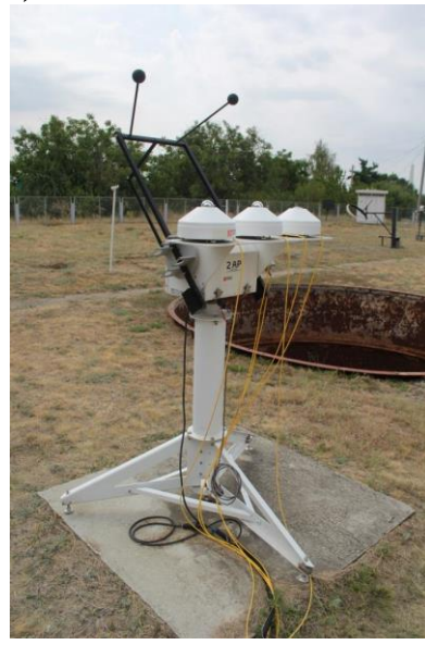
Рис. 2. Автоматизированный актинометрический комплекс (ААК). Трекер с датчиками на станциях Подмосковная (а), Санкт-Петербург (б), Цимлянск (в).
