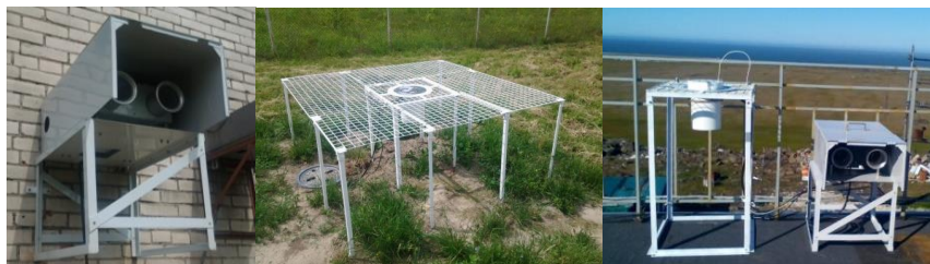
Рис. 3. Варианты установки выносных блоков измерителей E и L_{+-} .
