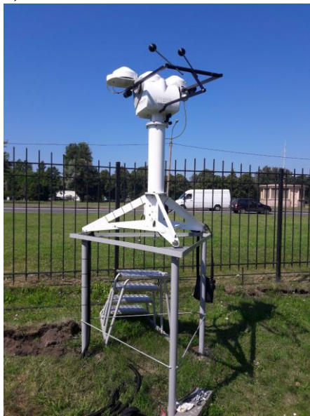
Рис. 2. Автоматизированный актинометрический комплекс (ААК). Трекер с датчиками на станциях Подмосковная (а), Санкт-Петербург (б), Цимлянск (в).
